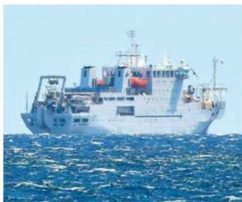
La nave Teliri Elettra Itc, imbarcazione ex Telecom, è specializzata nella posa dei cavi sottomarini
